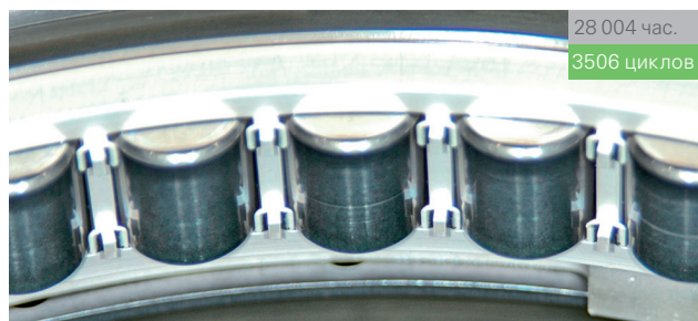
CF6-80C2, подшипник № 6 в маслоотстойнике
